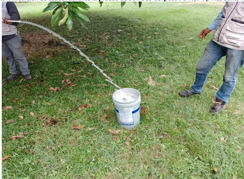
Figura 4.81. Medición de caudal durante la prueba de bombeo del pozo PB No. 4 (Finca Santa Rosita)
