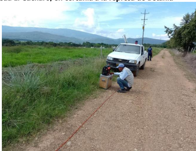
Figura 4.46. Geotomografía No. 3, realizada en la vereda El Cucharo, en cercanía a la represa de Betania
