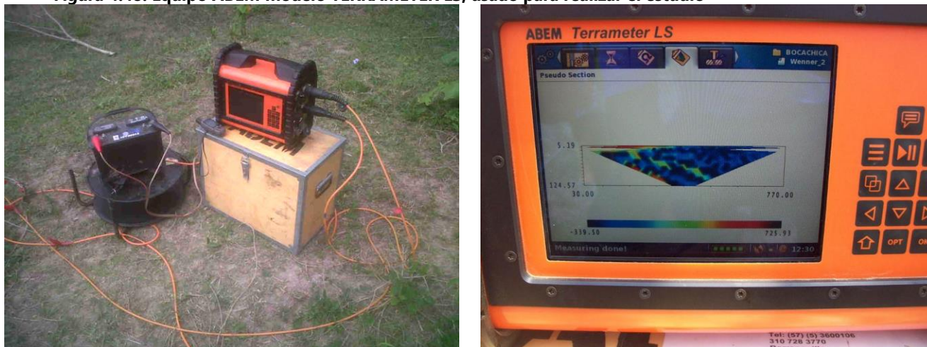
Figura 4.48. Equipo ABEM modelo TERRAMETER LS, usado para realizar el estudio
